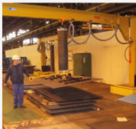
▶ Transport ciężkich płyt w poziomie
