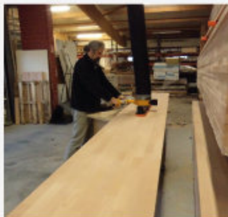
▶ Przenoszenie desek w poziomie
