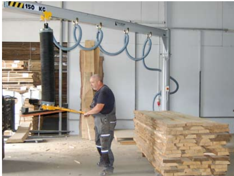
Manipulator MNP 150 jest zainstalowany na żurawiku niskiej zabudowy, z ramieniem o długości 5 m.
