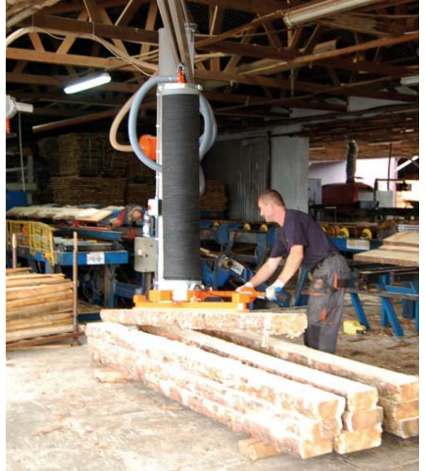
Uchwycenie, jak i podniesienie oraz przenoszenie ładunku odbywa się za pomocą podciśnienia, które jest wytworzone przez pompę podciśnieniową.
