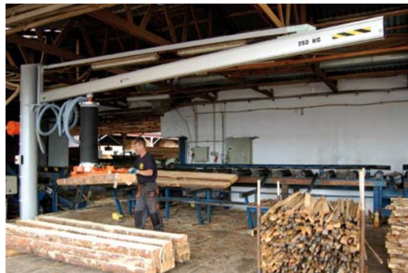
Żuraw, wraz z manipulatorem MNP200, zainstalowano przy rolkowych przenośnikach brusów i belek, za trakiem.
