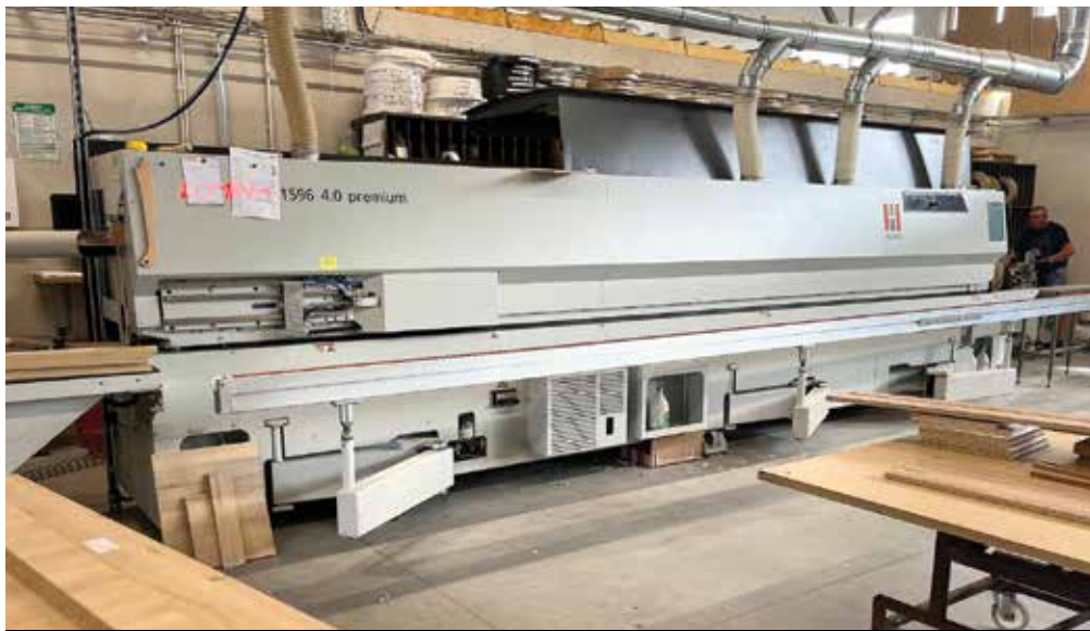
W zakładowej hali pracują okleiniarki marki Holzher.
