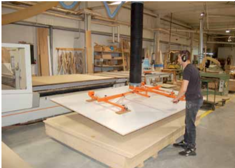
Dzięki inwestycji w manipulator maszyną obsługuje jeden operator, a nie jak wcześniej – dwóch.
