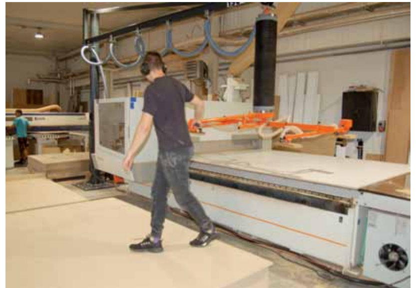
Urządzenie zostało zamontowane na przytwierdzonym do posadzki hali produkcyjnej specjalnym, metalowym słupie, u podstawy którego umieszczono także pompę.
